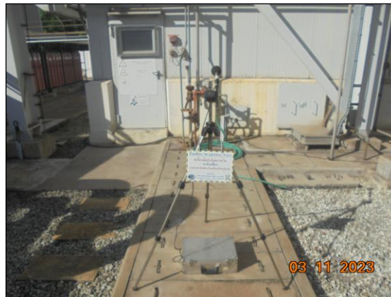
รูปที่ 3.12 การตรวจวัดระดับเสียงในพื้นที่ทำงาน บริเวณ Gas Turbine 3 - South
