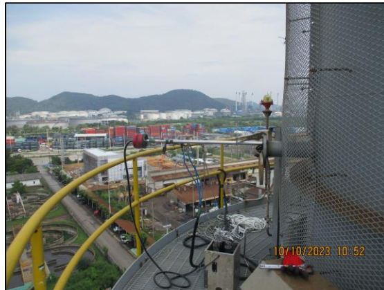
รูปที่ 3.1 การเก็บตัวอย่างคุณภาพอากาศในปล่องระบาย บริเวณ ปล่อง HRSG#3
