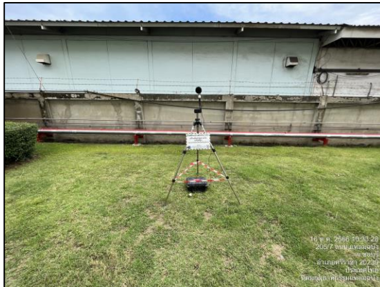
รูปที่ 3.5 การตรวจวัดระดับเสียงโดยทั่วไป บริเวณ ริมรั้วโรงไฟฟ้า
