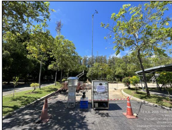
รูปที่ 3.2 การเก็บตัวอย่างคุณภาพอากาศในบรรยากาศ บริเวณ สำนักงานนิคมอุตสาหกรรมแหลมฉบัง
