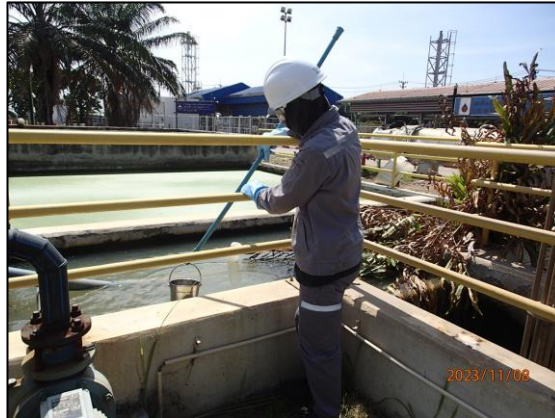
รูปที่ 3.8 การเก็บตัวอย่างคุณภาพน้ำทิ้ง บริเวณ จุดระบายน้ำของโรงไฟฟ้า ก่อนไหลลงรางระบายน้ำทิ้งของนิคมฯ
